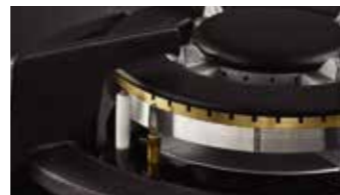
Gas Safety Technology Menjamin keamanan kompor karena terdapat thermocouple yang akan langsung menutup aliran gas saat api padam.
