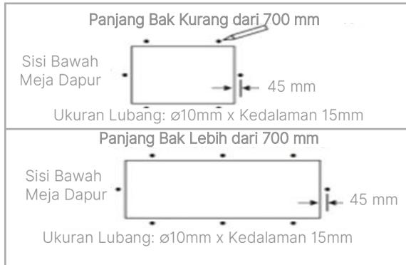
4. Masukkan jangkar sekrup plastik (*Fischer*) kedalam lubang-lubang yang telah dibuat.
