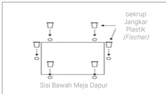
5. Pasang braket penahan (*fixing bracket*) pada bak cuci piring; geser braket ke posisi jangkar sekrup. Pasang sekrup yang sudah disediakan, tetapi jangan dikencangkan penuh.
