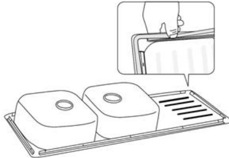
4. Pasang penjepit jangkar (*anchor bracket*) secara vertikal pada tepi bawah bak cuci piring dan tarik ke atas untuk mengunci bak pada posisi horizontal.
