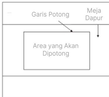
3. Lubangi bagian bawah meja dapur dengan bor seperti pada gambar di bawah ini.
