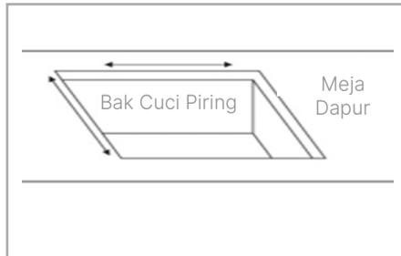
7. Pada area basah, oleskan *sealant* khusus yang cocok dengan bak cuci piring terbuat dari *stainless steel* (baja anti karat) dan bahan meja dapur.
