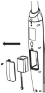
4. Sambungkan baterai baru ke konektor unit dan letakkan ke dalam
