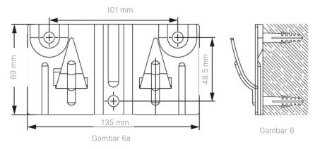
Metode Pemasangan ES 20SR: Setelah memilih lokasi yang tepat, tentukanlah posisi dari dua lubang pemasangan yang digunakan untuk baut tanam ekspansi (expansion bolt) dengan pengait (300mm). Buat dua lubang di dinding dengan kedalaman yang sesuai dengan menggunakan mata bor dengan ukuran yang sesuai dengan baut tanam ekspansi yang terpasang dengan mesin; masukkan sekrup *Fisher* (M8\*80); kencangkan baut/mur; kemudian, gantung pemanas air ini di atasnya (lihat Gambar 6b).
