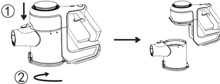
2. Lepaskan komponen siklon seperti ditunjukkan pada gambar dan bersihkan filter dengan sikat gigi. Jangan mencuci filter dengan air.
