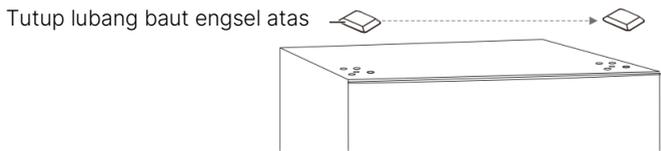
19. Kencangkan engsel atas ke sisi kiri atas kabinet dengan tiga baut yang Anda lepaskan sebelumnya. Sebelum Anda mengencangkan baut engsel atas, pastikan bagian atas pintu sejajar dengan kabinet dan paking karet membuat segel yang baik.
