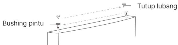
13. Lepaskan sumbat lubang baut engsel tengah di sisi kiri kabinet, lalu pasang di lubang baut di sisi kanan kabinet.
