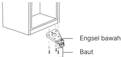
7. Lepaskan washer dan mur yang menahan poros pin ke lubang kanan pada engsel bawah, lalu lepaskan poros
