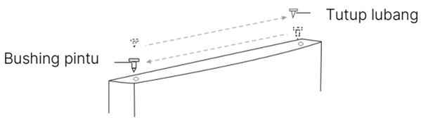
18. Lepaskan penutup lubang dari sisi kiri atas kabinet dan kencangkan penutup di sisi kanan atas kabinet.
