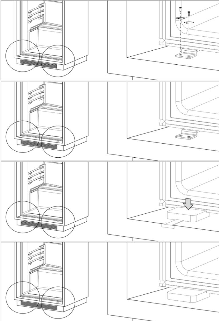
7. Pasang baut pada plat atas seperti pada gambar
