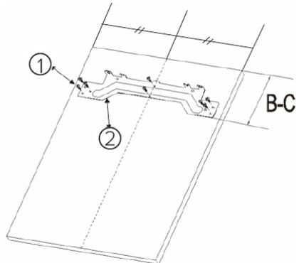
Tempatkan penutup dekorasi pintu pada pintu dengan cara memasukkan baut pengatur ke dalam slot braket. Cari ring dan pasang mur pada baut pengatur
