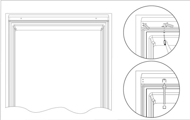
8. Pasang engsel pada plat samping kabinet
