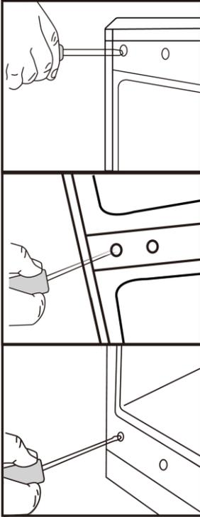
2. Dengan posisi pintu tertutup, lepaskan baut dari engsel atas dan bawah yang menempel pada pintu produk. Lepaskan baut dari engsel atas terlebih dahulu
