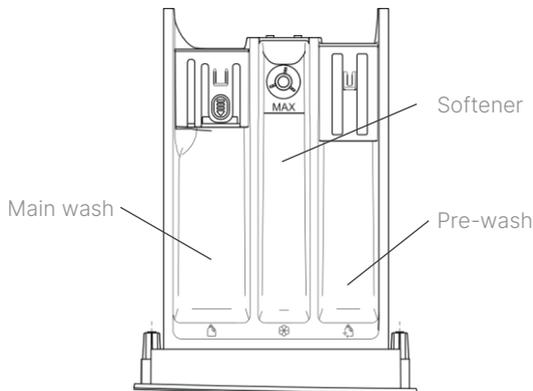
Kotak deterjen terbagi menjadi 3 bagian seperti pada gambar.
