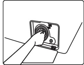
Pasang kembali ke mesin cuci dengan memutar searah jarum jam. Jangan mengoperasikan mesin tanpa filter!
