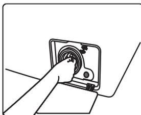
Pasang kembali ke mesin cuci dengan memutar searah jarum jam. Jangan mengoperasikan mesin tanpa filter!
